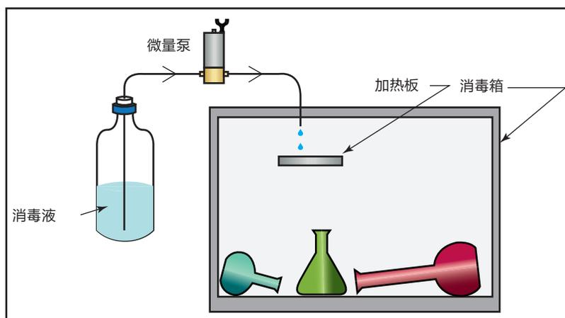
消毒液的纯度可能非常高，这意味着其成本也极高。在该应用中，百柯流体微量泵会从贮液器中取少量的消毒液，并会非常精确地将“几滴”消毒液分配到消毒室内部的加热板上。当消毒液接触到加热板时，会立即蒸发，在消毒室内形成“消毒蒸汽”。蒸汽可非常高效地对复杂组件的内部进行消毒处理。微量泵能够以高度可重复、一致的方式为消毒室提供消毒液。这种安全、高性价比的泵送高纯度液体的方法已取得了非常大的成功。
